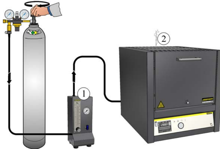
Fig. 44: Conexión al sistema de gasificación (figura análoga)
