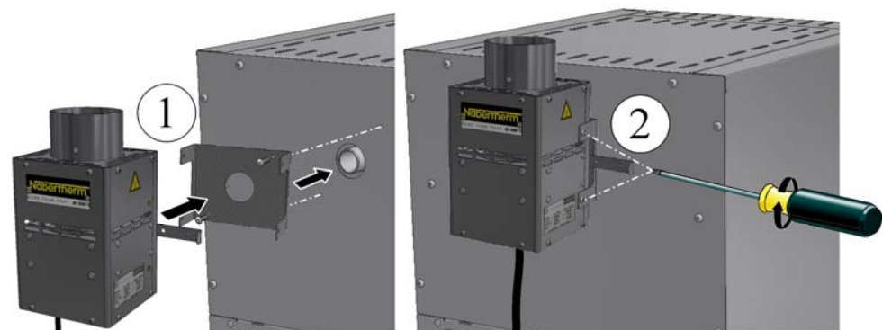
Fig. 18: Chimenea extractora con ventilador
