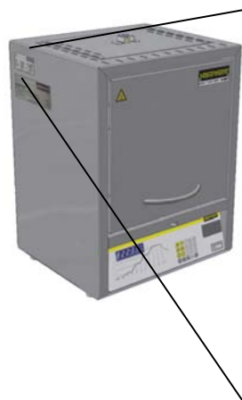
Fig. 12: Ejemplo: Nombre de modelo (placa de características)
